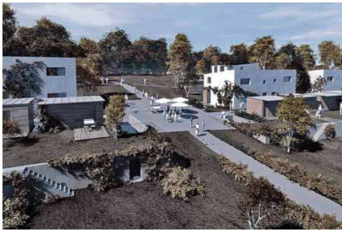
Durch die Tiefgaragen ergeben sich terrassenförmige Gärten, die sich um die neue „kommunikative Mitte“ des halböffentlichen Areals erstrecken. In den Pultdächern der kubischen Häuser sind Fotovoltaikkollektoren integriert. Grafiken: Dumberger/Lüps
